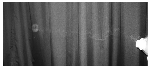
図 8 空気砲から発射された渦輪が飛行する様子
