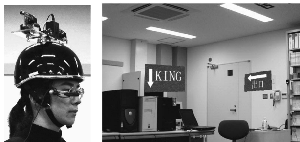
図2 赤外線マーカを用いるユーザ位置姿勢検出
