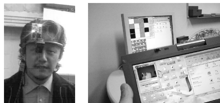
図4 VCCの利用状況。装着型VCCバッジ(左) ディスプレイ表示型VCCとその受信クライアント(右)
