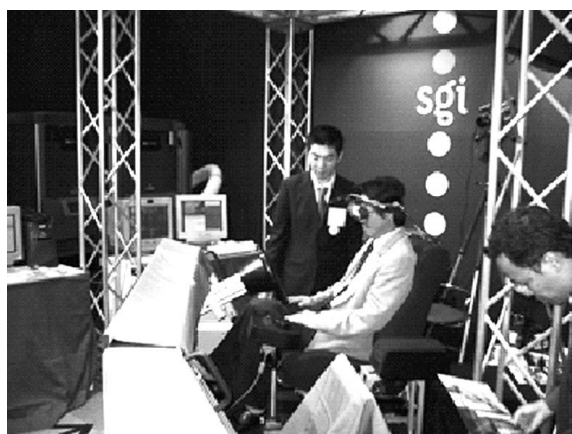
ビデオシースルーHMDを用いた自動車のデザインレビューシステム
