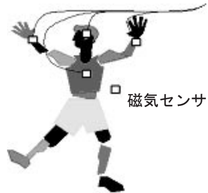
図3 GAVA™における磁気センサの装着
