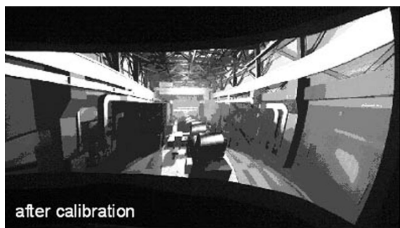
図2(b) 球面スクリーン上へ投影された映像(シームレス処理後)
