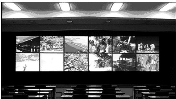
図3(a) 2×6プロジェクタ構成の背面投射プロジェクタアレイシステム(マルチ画面としての映像再生例)
