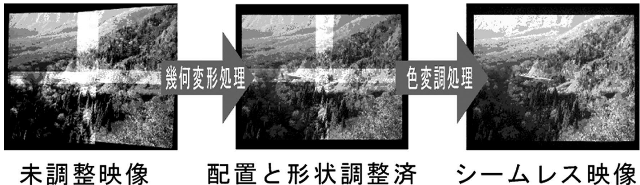
図1 2×2構成のプロジェクション映像のシームレス化プロセス
