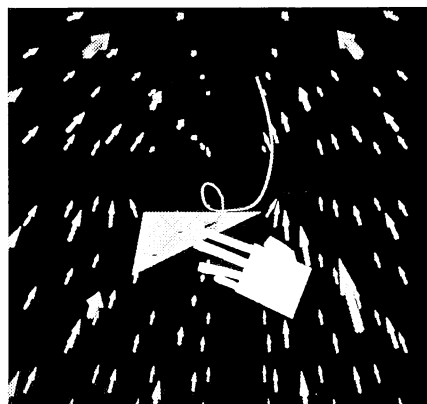
図5 三角翼まわりの流れを示す流線と速度ベクトル(CABINの1画面)
