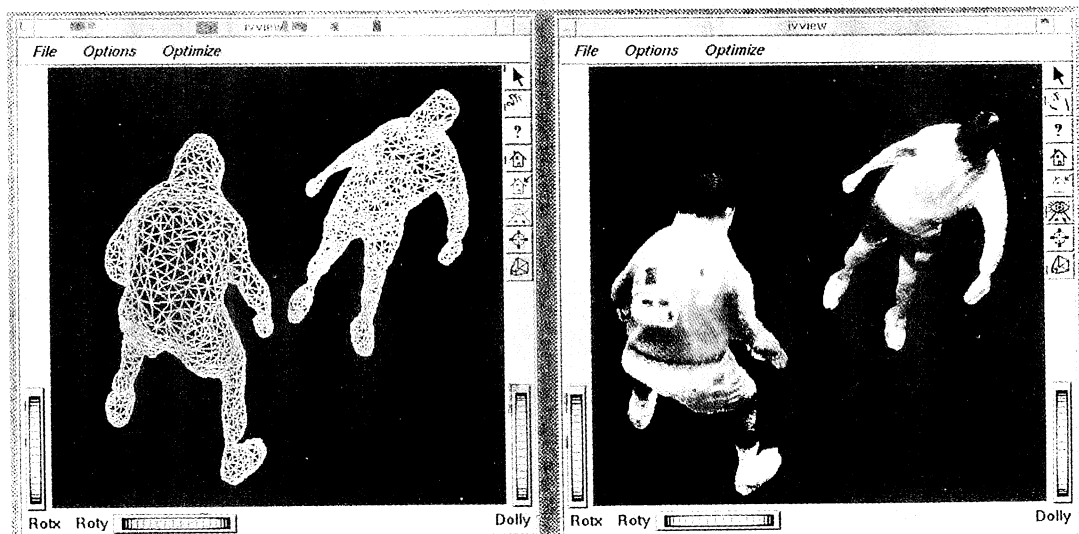
図3 一般の3次元モデルビューアで表示した3次元モデルの例。左はワイヤフレーム表示。右はテクスチャマッピング表示。
