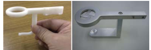
図9 ナビゲータの部品をABS樹脂で試作。これを十分使用した後、形を決定して右のように金属で最終製品を作成した。 (詳細は16頁参照)
