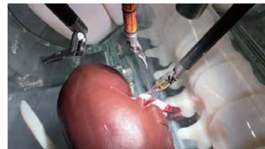
▲ (b) ウェット素材による生体質感腎臓モデルでのda Vinciロボット支援手術シミュレーション (上段: 腹腔シミュレータも3Dプリンタで造形 下段: 血管処理)
