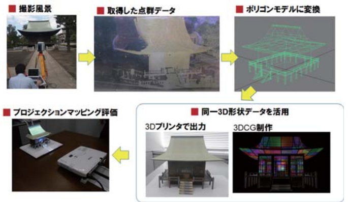
▲ 図17 プロジェクションマッピング製作工程で利用される3Dプリンタ 出典:アンビエントメディア 町田聡氏web siteより (詳細は38頁参照)
