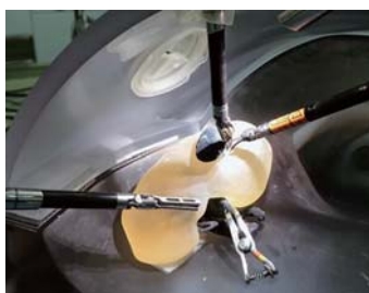
(a) ドライ軟性素材による生体質感腎臓モデルでのda Vinciロボット支援手術シ
