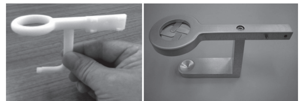
図 9 ナビゲータの部品を ABS 樹脂で試作。これを十分使用した後、形を決定して右のように金属で最終製品を作成した。(口絵にカラー版掲載)
