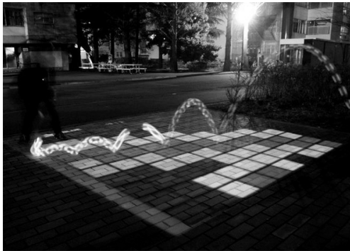
図 3 センサ・LED・無線を組み込んだボールでプレイする屋外での実験，地面にCGを投影（2008年）
