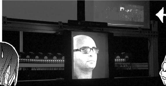
Kinectで顔認識をおこない、ユーザの頭部の位置に応じて像の見え方を調整することで縦方向の自由視点立体視も可能になる
