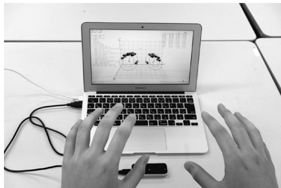
図 1 Leap Motion Controller 使用例
