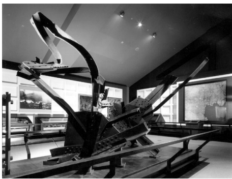
写真1 空襲で折れ曲がった鉄骨(提供:江戸東京博物館)
