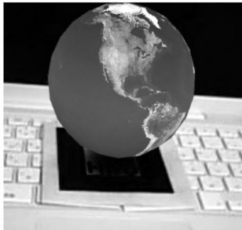
図 4 Collada 形式による外部 3D モデルを表示した例
