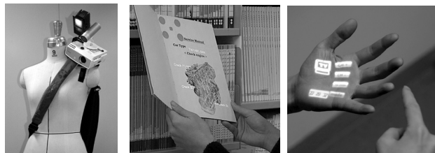
図4 ユビキタスプロジェクション：(左)システム外観、 (中央)印刷物へのアノテーション，(右)掌リモコン
