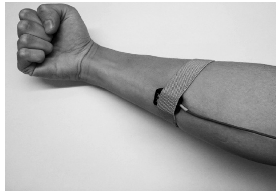
図3 積分型筋電センサの装着図
