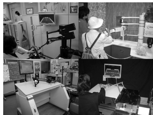
図4 ER アクチュエータ・ブレーキを用いた各種上肢リハビリ支援システム
