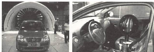
図3 風洞における自動車の風騒音試験
