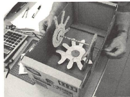
図12 割駒駆動カナと虫歯車の噛み合いを表す紙のモデル
