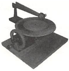
図 3 ベルリーナの円盤式 グラモフォン
