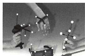
反射マーカを利用した、6DOFのトラッキングシステム。
