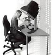
・力覚フィードバックとステレオ表示による高度にリアルなシミュレーション
