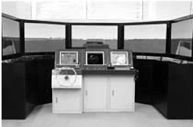
図3 操船シミュレータ (第二船橋)
